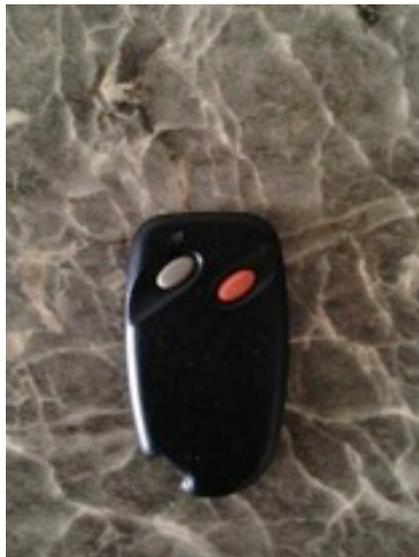
Als erstes wird die Fernbedienung in seine Einzelteile zerlegt, das macht man mit einem dünnen Schraubendreher oder mit dem Fingernagel
