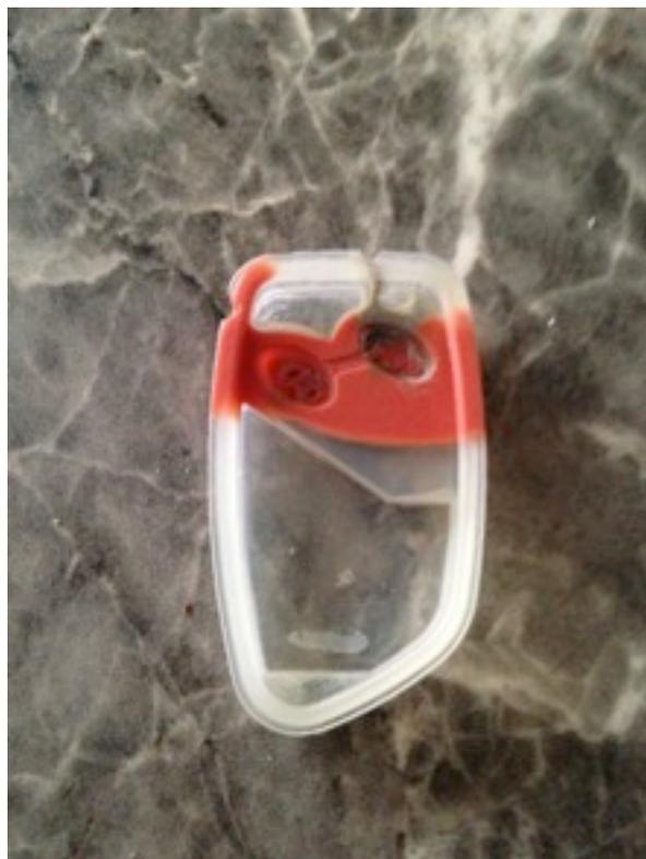
Jetzt wird die Gummihülle wieder um die Elektronik gelegt und alles wieder ins Gehäuse getan
